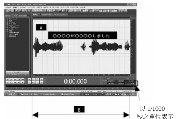
圖 5 所示為以音效編輯軟體量測話速實例。
