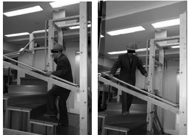
圖 18 高齡者使用內外兩邊扶手下樓例
