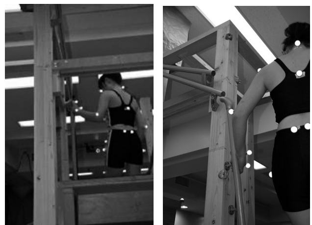
圖 15 下樓時使用內側傳統扶手例
