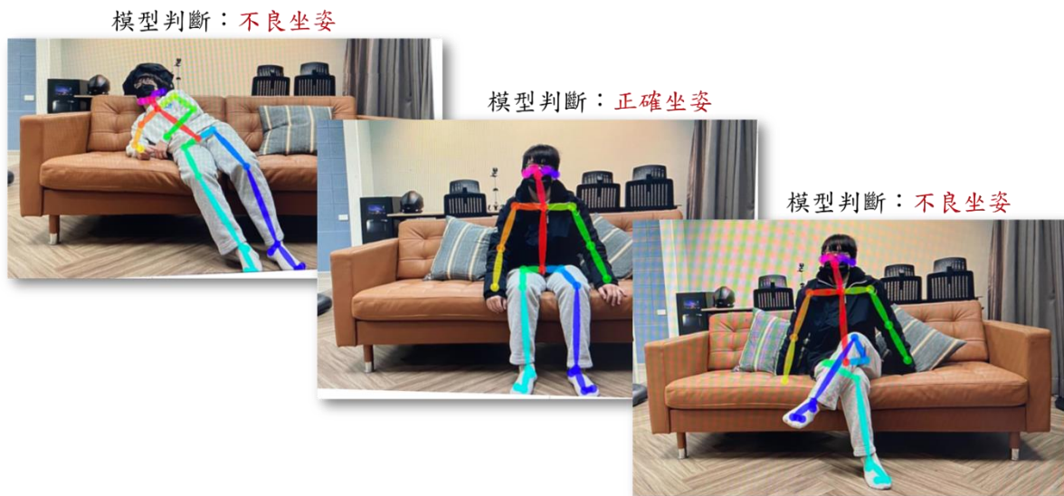
圖4、學生運用OpenPose開源軟體開發辨別使用者不良坐勢之應用程式
